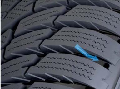
Mit einer Matschschleuder schützt der Nokian WR D3 vor Schneematsch-Aquaplaning. Die Matschschleuder schleudert Matsch und Wasser aus den Rillen des Reifens heraus und macht das Fahren sicherer. Polierte Rillen entfernen Matsch und Wasser zudem schneller.
