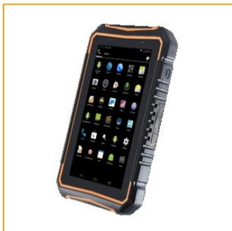
Das **C4 Tablet** ist unsere Tablet Ausführung unter den RFID Handhelds. Es weist einen **großen Bildschirm und ein robustes Design** aus. Das Gerät ist ein idealer Begleiter für **Anwendungen im Bereich von Planungsarbeiten in rauen Umgebungen wie Baustellen**. Dieses mobile Terminal ist in den RFID Frequenzbereichen: **UHF, HF, LEGIC und LF** verfügbar.
