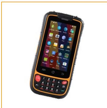
Das **C4 Green** ist eine schlanke Ausführung mit integrierter Tastatur unter den RFID Handhelds. Es hat eine **robuste Bauform**. Das **handliche Design** und die **Leichtigkeit** des Geräts machen es zu einem idealen Begleiter für **Anwendungen, die eine direkte Kommunikation erfordern**. Dieses mobile Terminal ist in den RFID Frequenzbereichen: **HF und LF** verfügbar.
