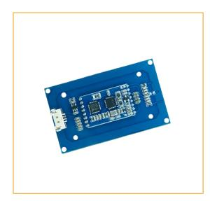
Die RFID Embedded HF Modul Serie R835 besticht durch seine integrierte Antenne. Das R835 RFID Modul eignet sich für viele Anwendungsmöglichkeiten innerhalb des medizinischen Bereichs, in Verkaufsautomaten zur Bezahlabwicklung oder auch im Rahmen des Zutrittsmanagements. Es ist verfügbar mit einer TTL-Schnittstelle und in vier verschiedenen Konfigurationen: DESFire, ISO 18000-3, PSAM, HF und MIFARE.
