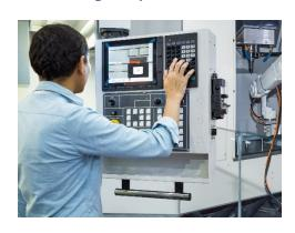
Maschinen in großen Produktionen für Anlagen erfordern einen authorisierten Zugriff. Die Integration des M890 Moduls in das Steuerungs-Panel einer Maschine schützt die Maschinensteuerung vor unbefugten Zugriffen. Der zuständige Mitarbeiter loggt sich mit Hilfe seines RFID Tags in das Panel ein. Das Steuerungs-Panel gibt dann die Steuerungselemente frei und der Mitarbeiter kann die Maschine bedienen.
