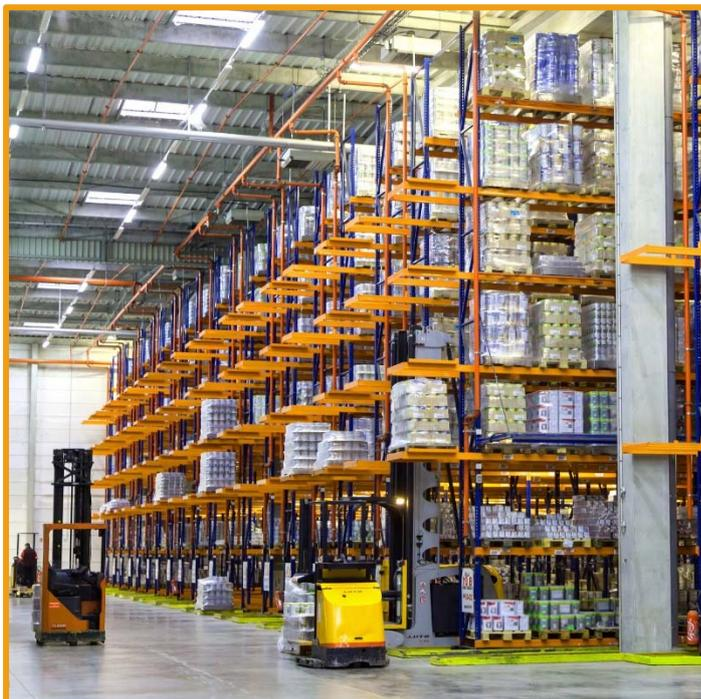
Paletten und Güter können mit Hilfe von angebrachten RFID Transpondern oder RFID Tags mittels der BLUEBOX Micro IA sicher identifiziert und einem Regal zugeordnet werden. Das RFID Industrie Lesegerät überträgt die Daten an den Monitor des Staplerfahrers und zeigt Informationen über Inhalt und Lagerort an.
