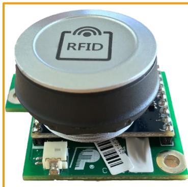
Die Übertragung der Daten kann auf zwei verschiedene Weisen erfolgen. Der Transfer aller Zugriffsdaten kann mit Hilfe des **Virtual COM Port Modus per USB Kabel** und speziellen Kommandos übertragen werden. Der **VCP Modus bietet einen vollständigen Lese- und Schreibzugriff** für alle unterstützten Transponder. Im **HID Modus** können Benutzerdaten von den unterstützten Transpondern als Tastaturemulation abgerufen werden.
