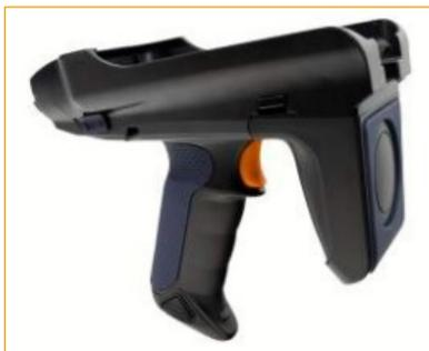
Der **Mobile Computer M3 SM15** ist mit einem **2D Barcode Reader** oder einem integrierten **NFC Reader** ausgestattet. Der optional erhältliche **Long-Range-Scanner** erfasst valide alle 2D Barcodes auf RFID Labels oder RFID Etiketten bis zu einer **Reichweite von bis zu 15 m**. Der integrierte **RFID HF und NFC Reader** liest RFID Tags und RFID Transponder des ISO Standards **ISO 14443A/B und ISO 15693**
