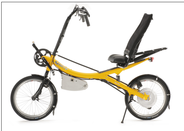
HP Velotechnik rüstet das Sesselrad Spirit auf Wunsch mit einem kraftvollen Elektro-Hilfsantrieb aus.
